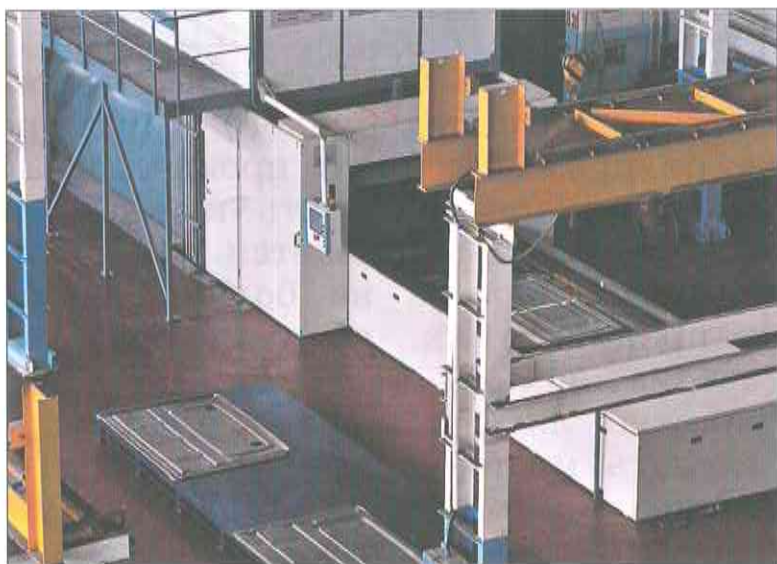
Пресс для штамповки кузовов на автомобильном заводе
